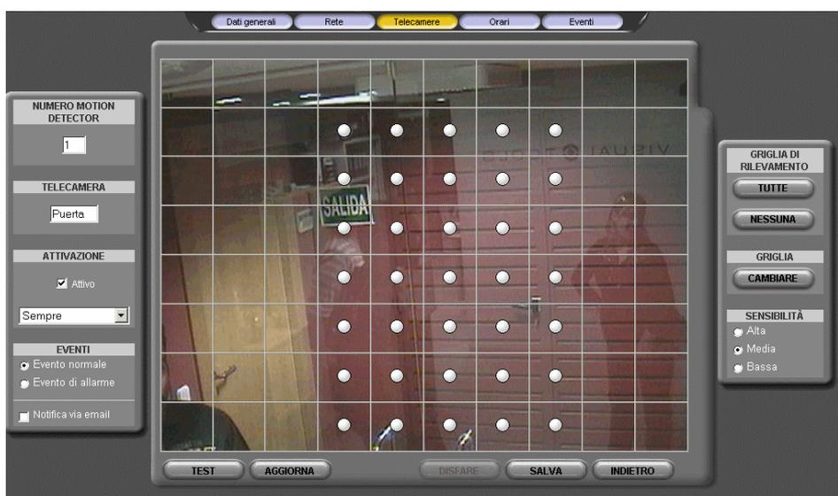
Fig. 44 – Schermata di configurazione: rilevazione del movimento
