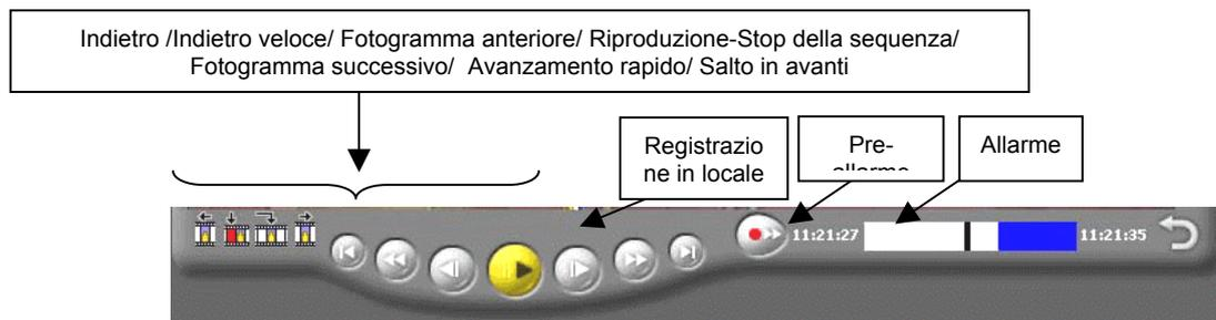
**Fig. 34 – Controlli per la riproduzione del video registrato**
