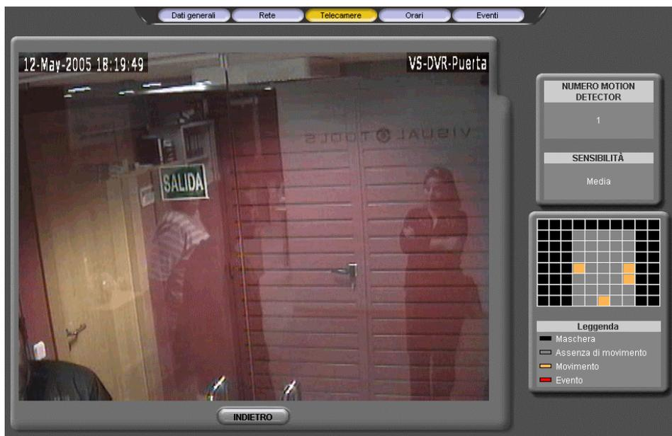
**Fig. 45 - Schermata di configurazione: Test del motion detector**
