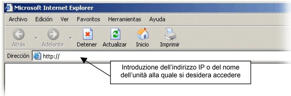
Fig. 2 - Connessione ad un VS-DVR
