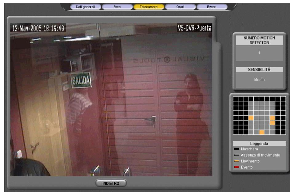
Fig. 40 - Schermata di configurazione: Test del motion detector
