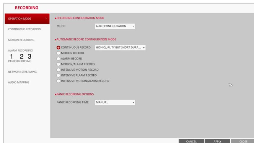
2. Impostare la **MODALITÀ DI CONFIGURAZIONE DELLA REGISTRAZIONE** su **CONFIGURAZIONE AUTOMATICA**.
