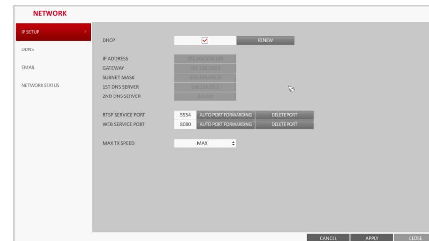
**Nota** Inserire un indirizzo IP che rientri nell'intervallo di IP privati forniti dal router (per esempio: 192.168.1.2~254, 192.168.0.2~254, ecc.).
