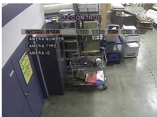
Figura 3-11 Schermata di impostazione del controllo PTZ
