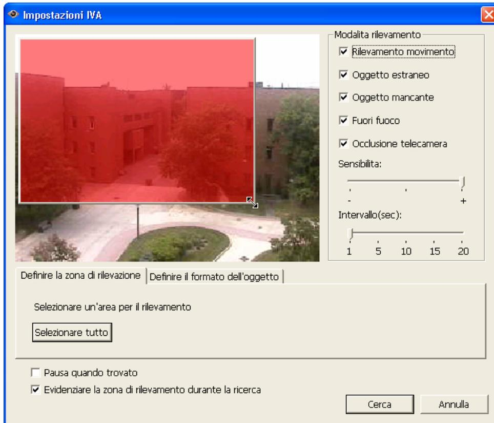
7. Definire il formato dell'oggetto per la rilevazione. E' possibile utilizzare il mouse per trascinare la zona gialla per evidenziare il formato minimo dell'oggetto per la rilevazione.
