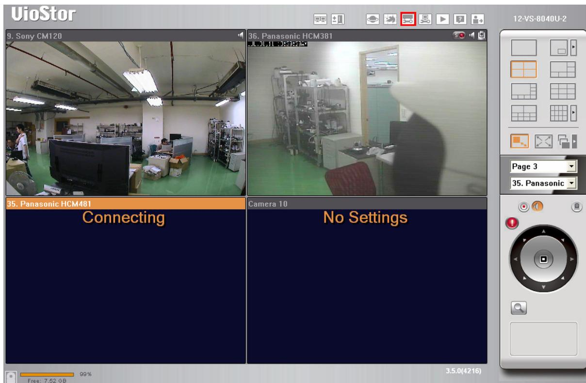
Una volta effettuato il login, nella pagina "Modalità avanzata" vengono visualizzati i canali di monitoraggio, lo stato di connessione e registrazione e la larghezza di banda di rete di NVR.
