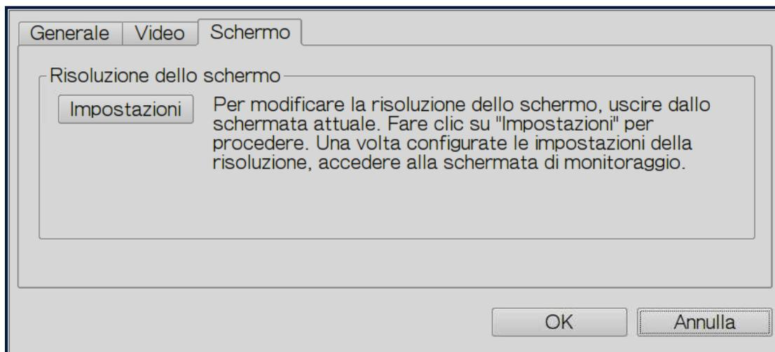
Se il modello di monitor non può essere rilevato, il videoregistratore di rete NVR fornirà le opzioni 1400x1050, 1280x1024, 1024x768.
