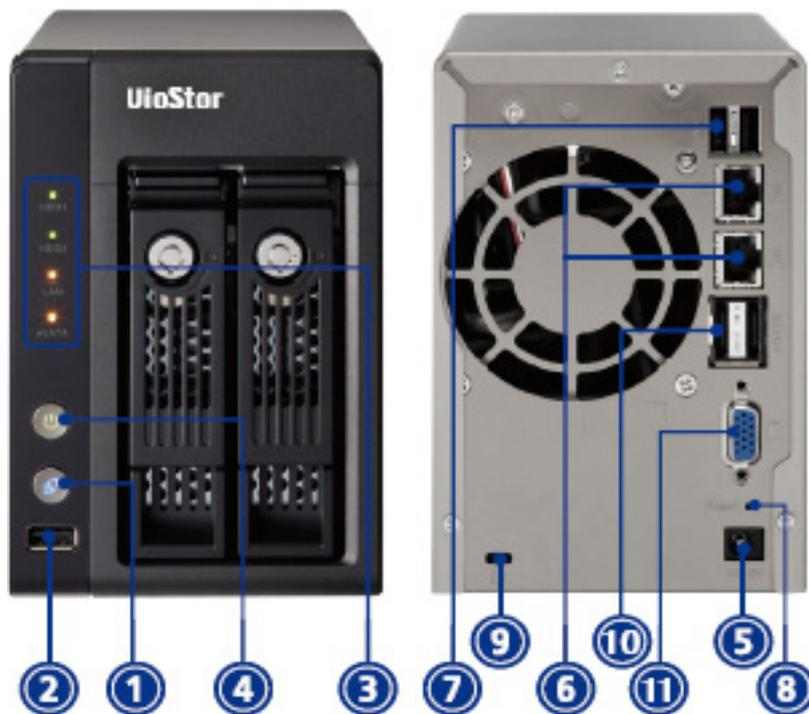
1. Sicherungstaste (Autom. Videosicherung durch Drücken der Taste)
