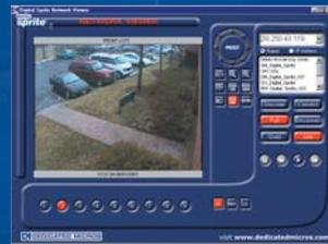
Tutto ciò è possibile grazie a un sistema di visualizzazione in rete indipendente che fornisce: controllo dei dispositivi, anteprima eventi, la possibilità di visualizzare le telecamere nascoste e, naturalmente, una protezione totale tramite password.
