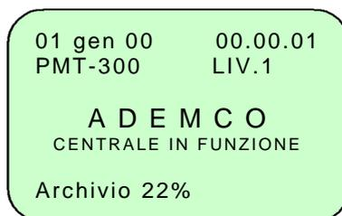
Sulla seconda riga sono visualizzati la sigla della centrale e il livello di accesso alle procedure operative: più' alto è il livello, maggiore è il numero di procedure accessibili.
