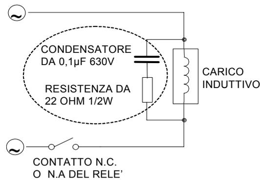
**L'inserimento di un dispositivo di recupero (diodo o RC) è importante per evitare che possano generarsi scintillii sui contatti del relè con conseguente deterioramento precoce degli stessi e con possibilità di malfunzionamento della centrale (gli scintillii causano forti disturbi elettromagnetici che possono resettare o addirittura bloccare il microprocessore della centrale o dei moduli di espansione).**
