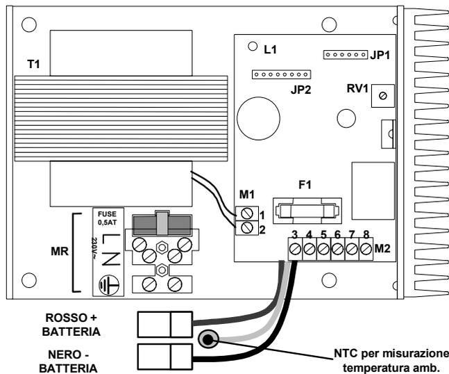
**RV1:** Trimmer di taratura della tensione di uscita regolata. **NON MODIFICARE L'IMPOSTAZIONE DI FABBRICA.**
