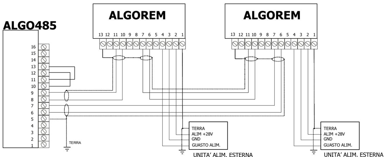
7.4.4 COLLEGAMENTO LOOP CON ALIMENTAZIONE DA CENTRALE
