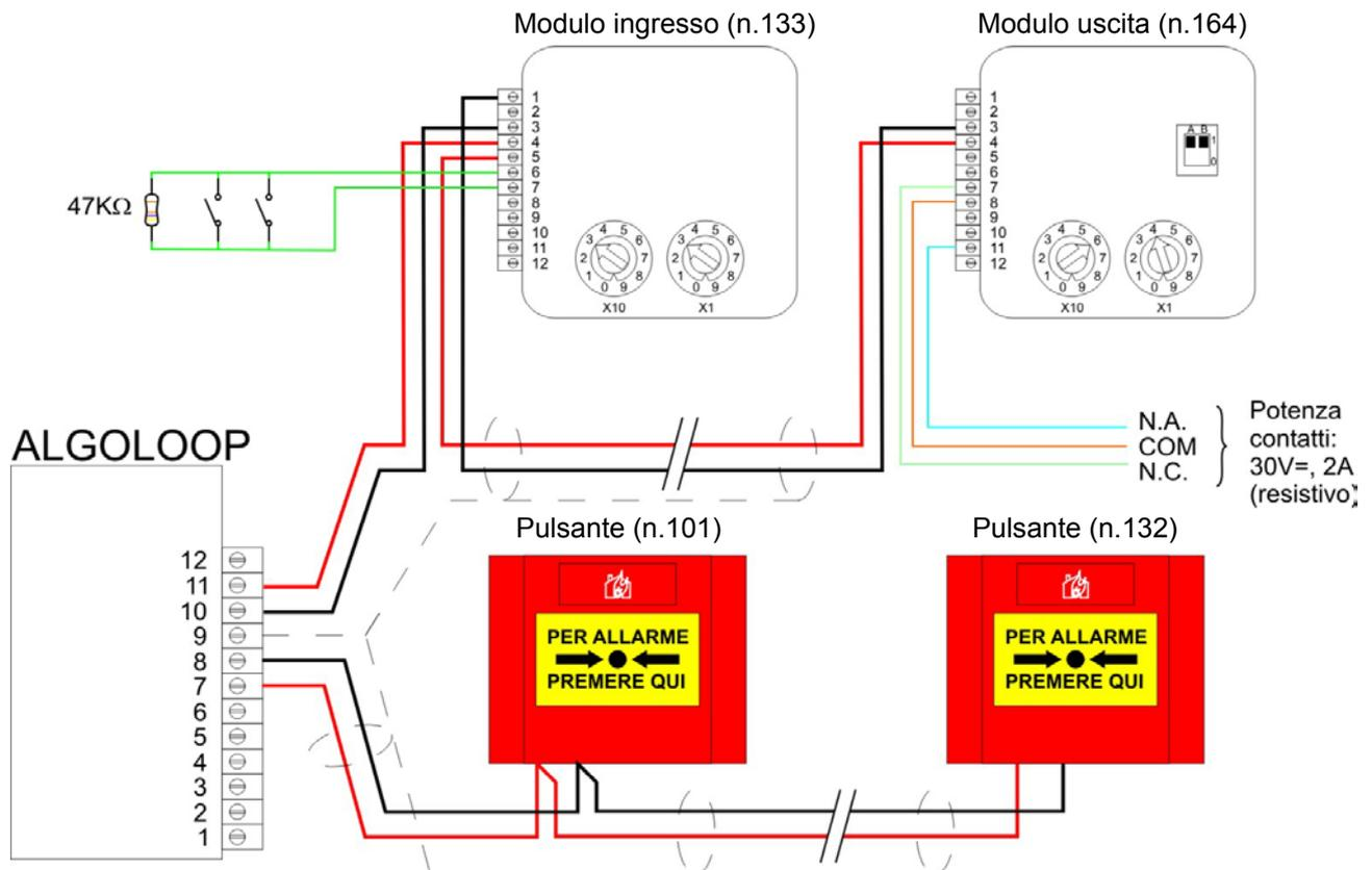
**NOTA** Il collegamento a linee aperte prevede che il dispositivo ALGOLOOP non effettui il test di continuità del loop. E' quindi necessario che tale funzione sia disabilitata come indicato al par.7.8.2 relativamente allo switch S1 - dip3.
