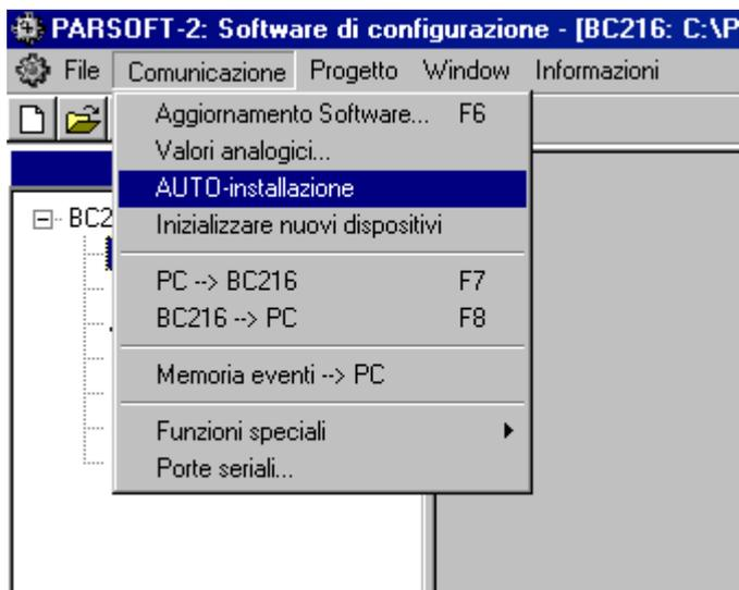
Questa operazione configura la centrale e carica i parametri sul PC; al termine di essa, la centrale si deve autoresettare.
