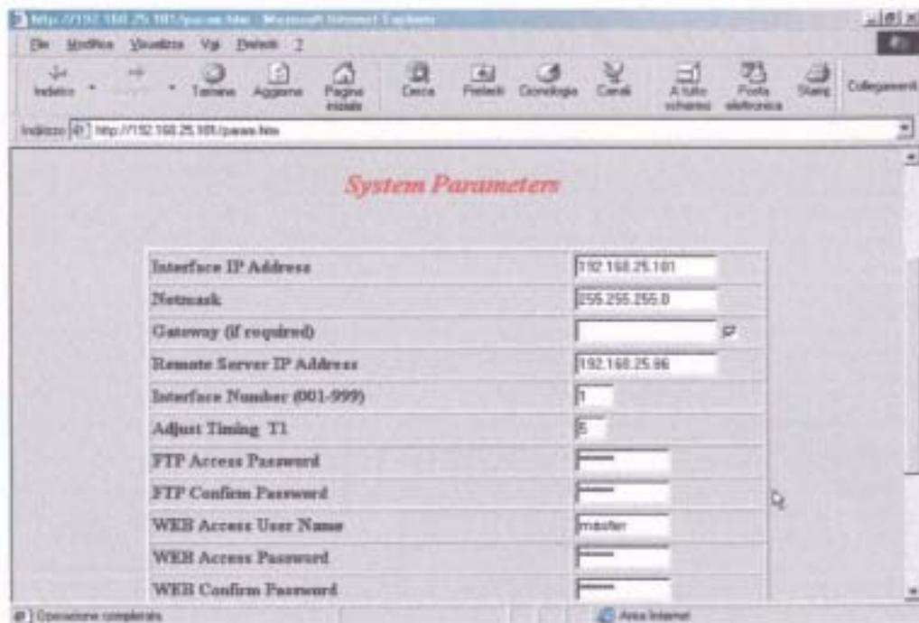
Esempio di configurazione di una interfaccia attraverso browser.
