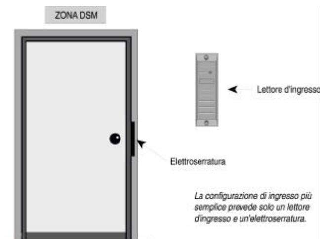
Come indica il nome, il Monitoraggio Stato Porta consente al sistema di sorvegliare costantemente il varco e di segnalare ogni cambiamento di stato. Informa il sistema quando l'apertura di una porta è stata forzata o quando la porta è stata mantenuta aperta dopo l'accesso per un tempo superiore al consentito. Senza il MSP, come nell'esempio 1, il sistema stabilisce solo se può autorizzare l'accesso. Non controlla lo stato del varco e non rileva niente di anomalo.
