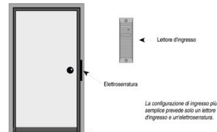
In questa configurazione, l'utente presenta il badge al lettore per ottenere l'accesso al varco. Il lettore legge i dati contenuti nel badge e PassPoint determina se esistono le condizioni per autorizzare l'accesso. Se l'accesso viene autorizzato, il relè di controllo della serratura viene attivato e l'elettroserratura si apre, lasciando transitare l'utente.
