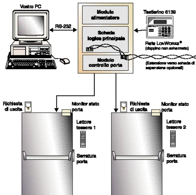
**Access Starter Kit nella configurazione di sistema tipica**
