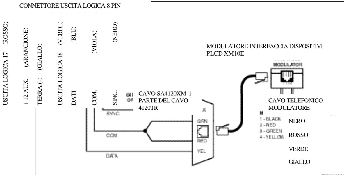
Cablaggio interfaccia XM10E dispositivi PLCD
