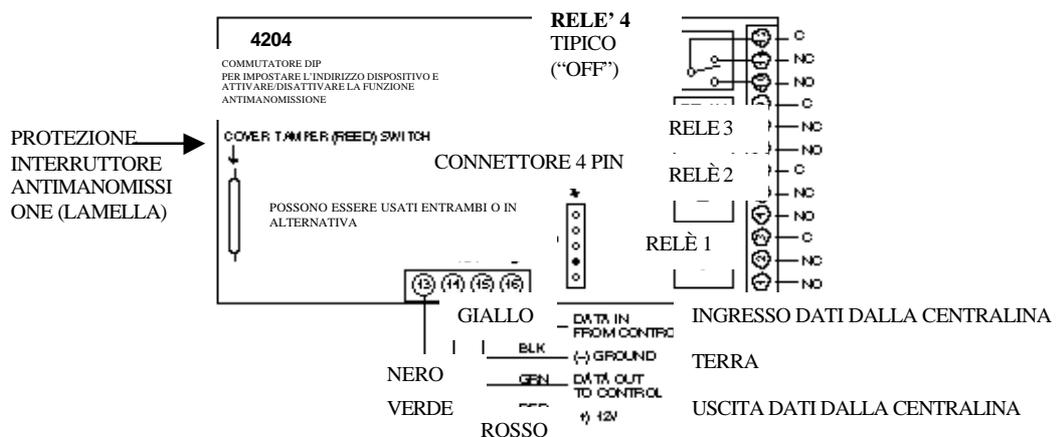
Figura 11. Cablaggio modulo 4204 alla centralina
