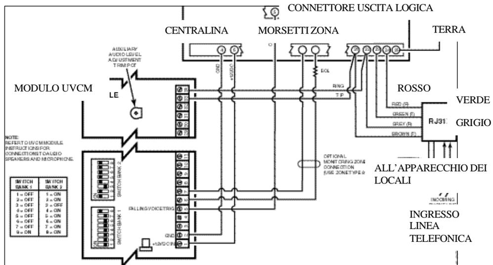
Figura 14. Cablaggio modulo AAV
