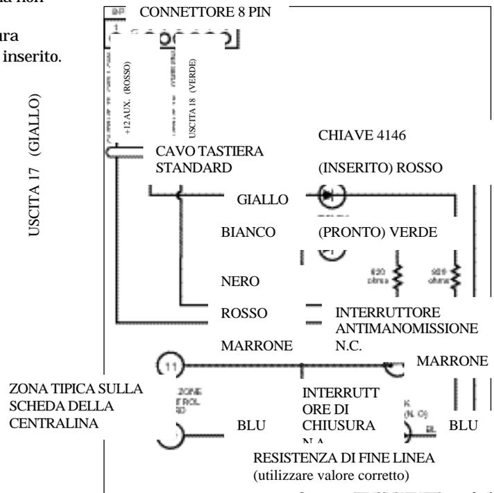
Figura 10. Cablaggio chiave
