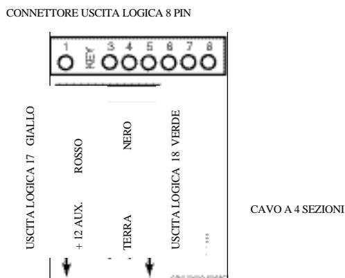
Figura 13. Connettore uscita logica a bordo con cavo a 4 sezioni in combinazione solo con uscita logica
