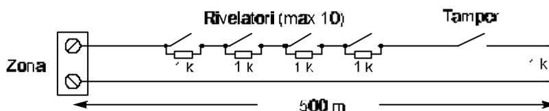
**Figura 2-10. Cablaggio di più rivelatori su di un'unica zona**
