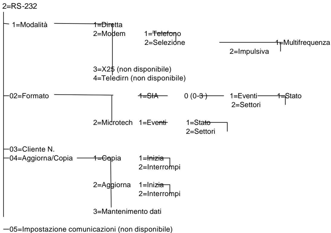
Il modulo interfaccia RS-232 é una interfaccia bidirezionale per la comunicazione tra la centrale di allarme ed un Personal Computer. essa può essere utilizzata per:
