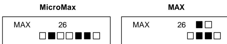
Il numero del bus è rappresentato nella fila superiore dei LED del MAX e dal 2° e 3° LED del MicroMax (dall'alto). Gli indirizzi sono rappresentati nella fila inferiore dei LED del MAX e dal 4° al 7° LED del MicroMax. Il primo LED del MicroMAX, il primo da sinistra nella rappresentazione sul display della tastiera, è sempre spento.
