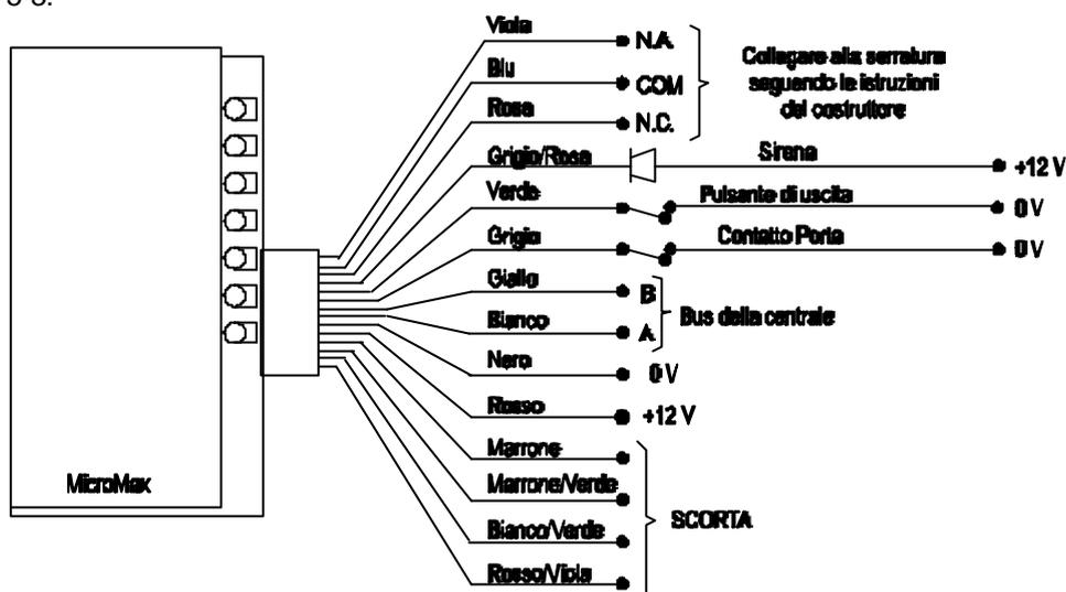
Figura 5-3. Collegamenti del MicroMax
