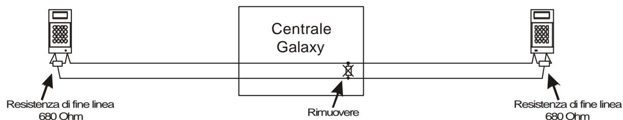
Figura 2-7. Collegamento di due rami della stessa linea
