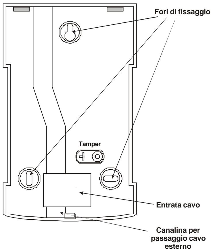
**Figura 4-2. Dettagli per il fissaggio della tastiera**
