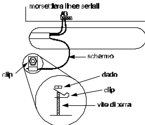
**Figura 2-8. Collegamento del cavo di terra**
