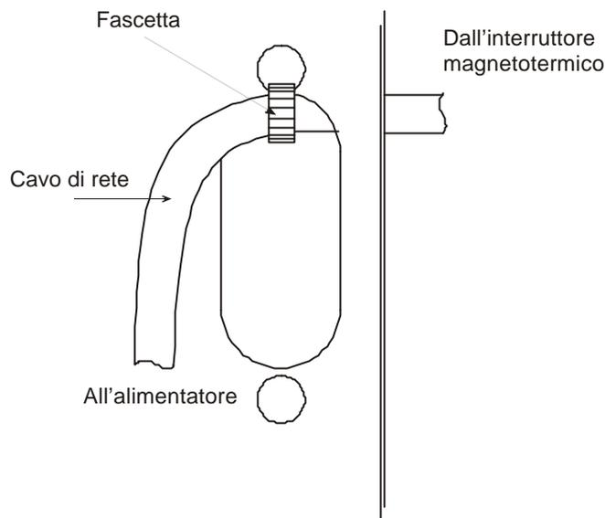
**.Figura 2-5. Fissaggio del cavo di rete alla centrale**
