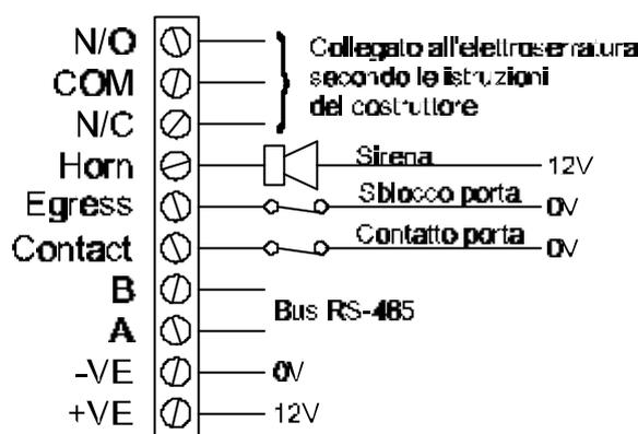
Figura 5-1 - Cablaggio del MAX
