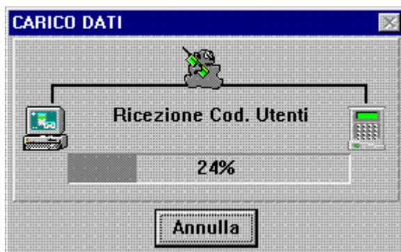
Il trasferimento dei dati di programmazione viene effettuato nella sequenza degli elementi selezionati. L'andamento di ciascun elemento viene visualizzato come una barra di stato e dal dato percentuale dei dati trasferiti. Al termine del trasferimento dei dati, viene visualizzato il messaggio **Trasferimento Completato**. Fare click sul pulsante **Ok** o premere il tasto **Enter** per cancellare la finestra.
